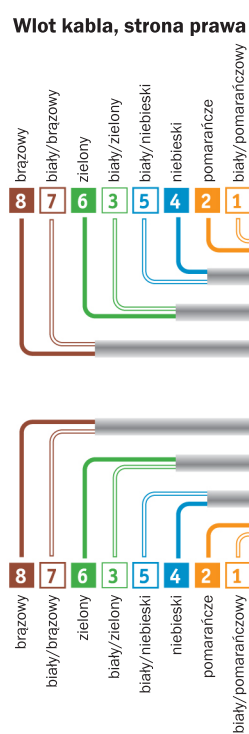
Konfiguracja wg EIA/TIA 568 B
